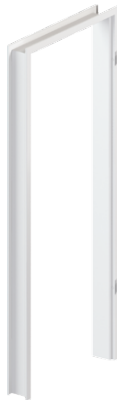
ЪГЛОВА КИСЕЛИНОУСТОЙЧИВА КАСА 100 мм интериорна метална каса, изработена от киселиноустойчива стоманена ламарина или от стоманена ламарина, облицована с PVC
